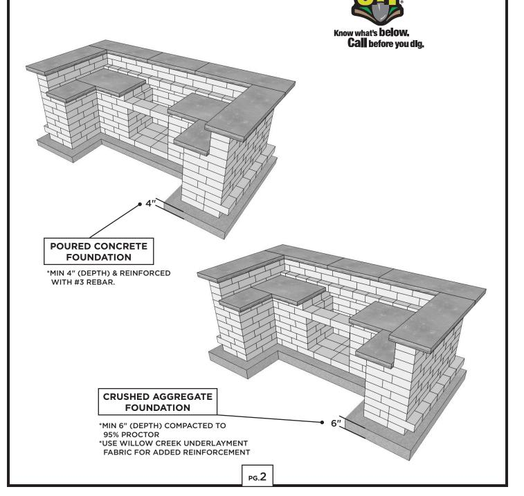
STEP 1 46: FULL LEDGESTONE ™ UNITS 2 LEDGESTONE ™ UNITS CUT TO 4"(w) x 8" (d) STEP 2 42: FULL LEDGESTONE ™ UNITS 2 LEDGESTONE ™ UNITS CUT TO 4"(w) x 12" (d)
