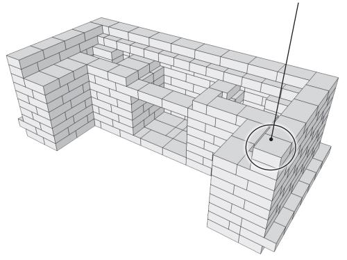
17: FULL LEDGESTONE ™ UNITS STEP 11 1 LEDGESTONE ™ UNIT CUT TO 8"(w) x 8" (d) STEP 12 TRIM COUNTER TOPS TO FIT
